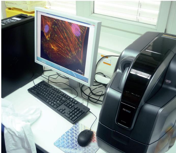
Fluoreszenzmikroskop zur Analyse von Morphologie und Anhaftung von kardiovaskulären Zellen
